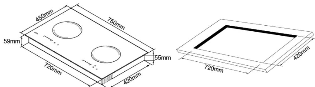
櫃體安裝孔中間請留隔板，隔板左右留兩孔至少100mm面積孔位(如下圖所示)，孔位為熱氣循環用，可任意形狀。
